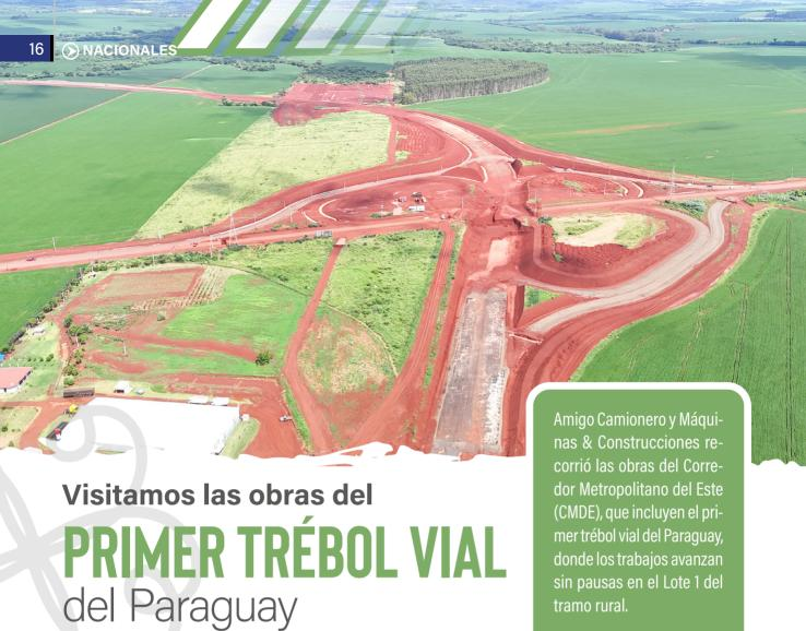
n entronque tipo trébol, también conocido como intercambio tipo trébol, es una intersección vial compleja diseñada para permitir el flujo eficiente y seguro del tráfico entre varias direcciones. Su diseño, que se asemeja a un trébol, consta de rampas y giros entrelazados que permiten a los vehículos cambiar de dirección
