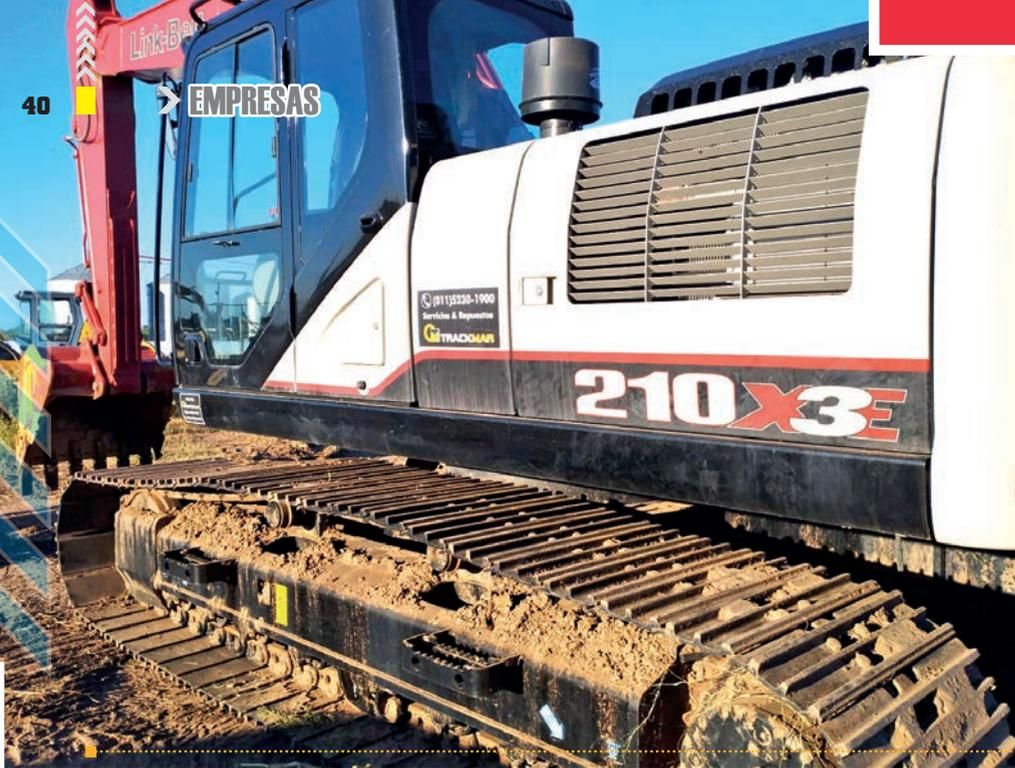
Las orugas anchas proporcionan estabilidad para excavadoras en operaciones de limpieza y dragado por su capacidad de "flotación", ya que cuentan con más área de contacto con el suelo. Las excavadoras sobre orugas constituyen la mejor solución para ejecutar trabajos en terrenos irregulares o con suelos sueltos, que no requieren de grandes desplazamientos. Dicho tipo de equipamiento no sobrepasa los 5 km/h.
