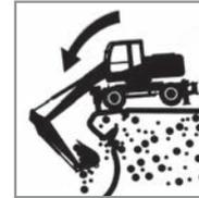
No excave por debajo de la máquina o estabilizadores
