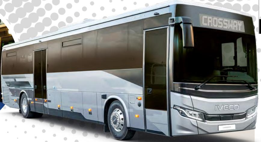
gitud, equipado con un motor Tec-tor 7 EURO VI-e de 320 CV (235 kW) y caja de cambios ZF. En el interior, la distribución incluye 53 plazas, 2 asientos reclinables, aire acondicionado, maletero de 5,1 m<sup>3</sup> + compartimento superior de 3 m<sup>3</sup>.
