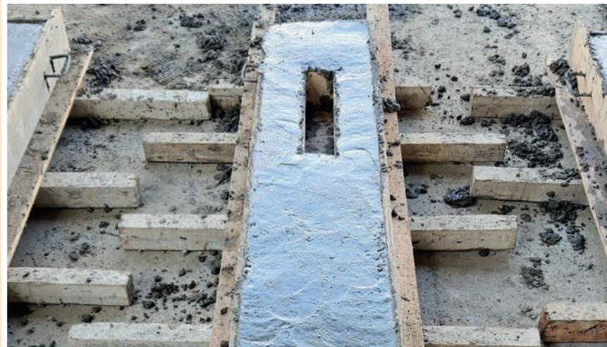
con 3 tipologías distintas: vigas macizas (padrón) de 2,20m de largo y sección 12x30cm; vigas con aberturas sin reforzar, de las mismas dimensiones que la maciza, pero con una abertura rectangular de 12x48cm centrada respecto a la altura de la viga y a 26cm del borde libre; vigas con aberturas con armadura de refuerzo, con las mismas dimensiones geométricas y de la abertura que la tipología anterior, siendo 3 modelos o cuerpos por cada tipología.
