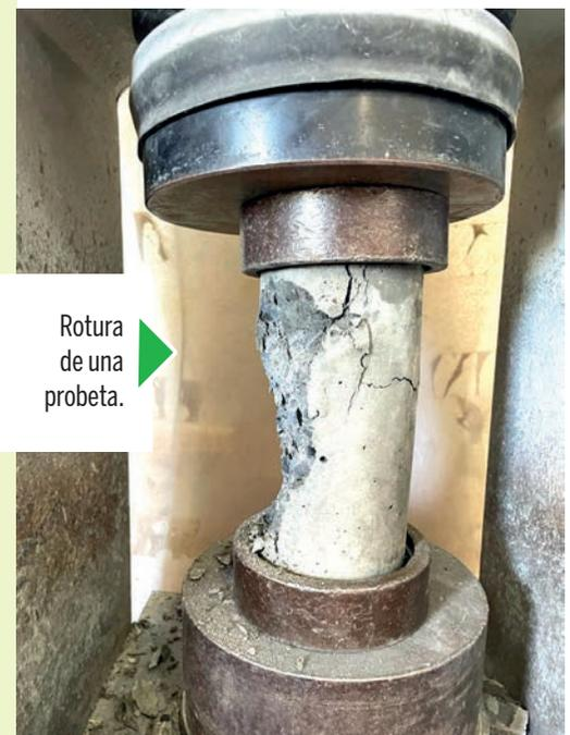
Rotura de una probeta.
