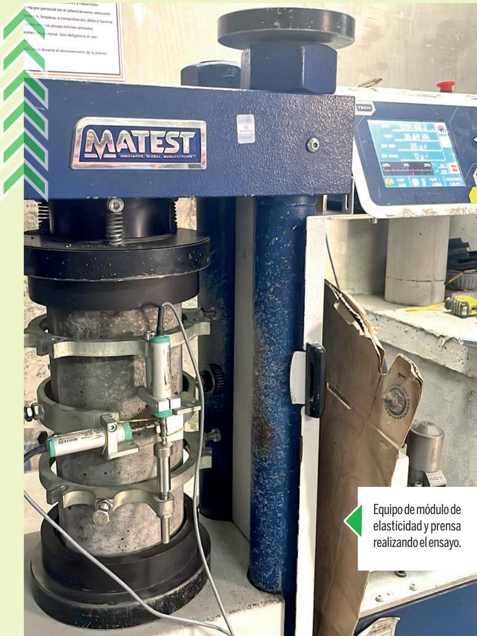
Equipo de módulo de elasticidad y prensa realizando el ensayo.
