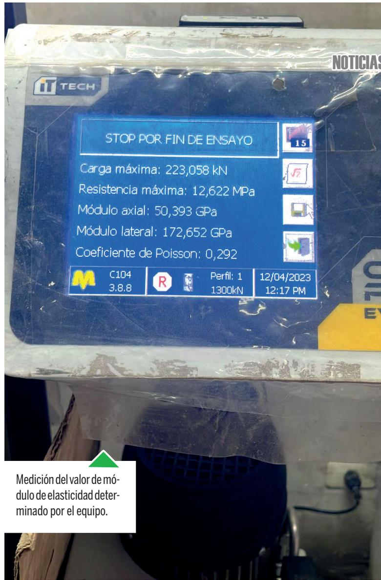
Medición del valor de módulo de elasticidad determinado por el equipo.
